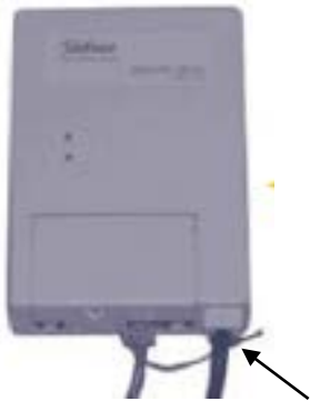
Terminador de red nº 1. A diferencia del PTR, llevan electrónica incorporada en el equipo, por lo que requieren alimentación.
